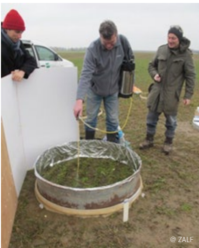
Die Lysimeteranlage (Hexagon 1) der ZALF-Versuchsstation in Dedelow (Bild rechts). Die ZALF-Mitarbeiter Marcus Herbrich, Jörg Haase und Dr. Horst H. Gerke (v.l.n.r.) beim Auftragen einer Bromid-Tracerlösung auf die mit Luzerne bewachsene Oberfläche eines Lysimeters (Bild links).
