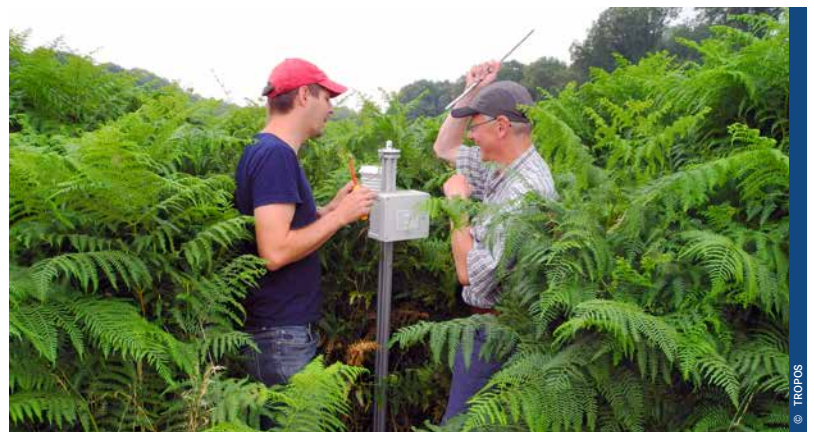
Rund 100 Pyranometer hatten TROPOS-Wissenschaftler in der Nähe von Jülich installiert. Diese Geräte erfassen die solare Einstrahlung.
