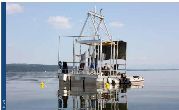
Mittels einer Bohrplattform sammeln Forscher Sedimentkerne vom Grund des Ammersees.
