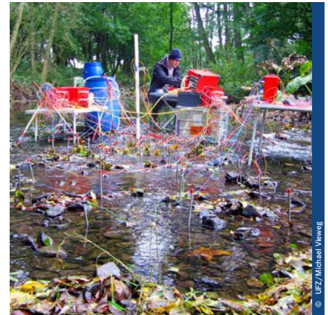
An der Schnittstelle zwischen Oberflächen- und Grundwasser: geoelektrische Messungen des Strömungsfelds innerhalb einer Kiesbank.
