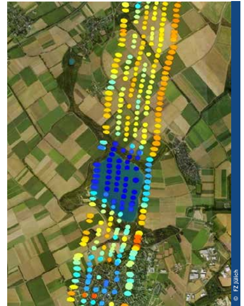
Radiometer liefern exakte Daten zur Bodenfeuchte, aber in geringer räumlicher Auflösung, hier Messungen beim Überflug über den Blausteinsee in der Nähe von Jülich.
