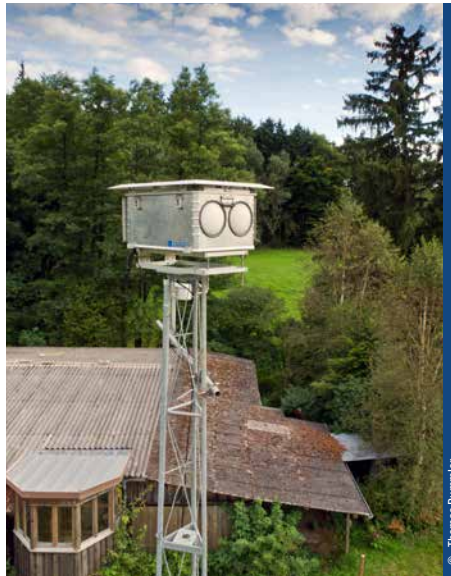
Am Standort Fendt im TERENO-Observatorium „Bayrische Alpen/Voralpen“ steht ein neu entwickeltes Mikrowellen-Messsystem, mit dem Luftfeuchtigkeit und Niederschläge nahe der Oberfläche erfasst werden können.
